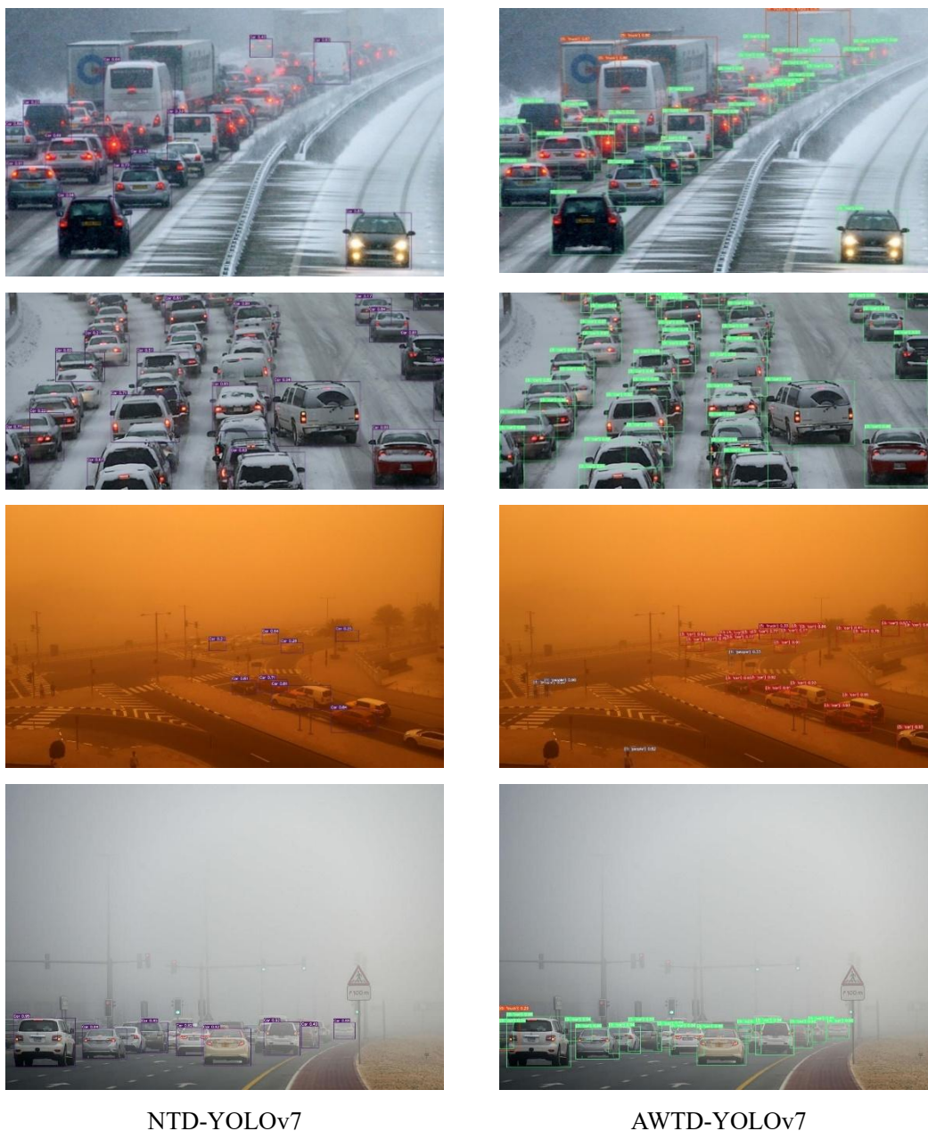
图 5-13 特殊天气下 NTD-YOLOv7 和 AWTD-YOLOv7 检测效果对比图
