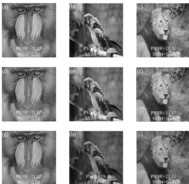
图 4-12 全息重构的仿真结果对比：(a)-(c) 基于近似二次相位的非迭代优化算法的全息重建结果；(d)-(f) ACIA 算法的全息重建结果；(g)-(i) GS 算法的全息重建结果
