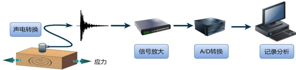
图 1-3 AE 检测原理
