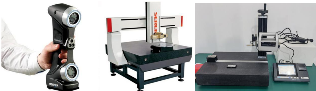
(a) 激光扫描仪图片 (b) 平面激光测量仪外观图 (c) 机械测量粗糙度图片
