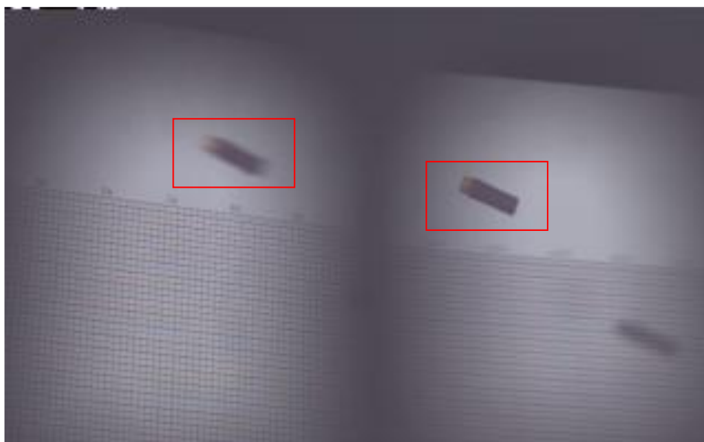
图 2-4 不旋转振镜和旋转振镜的对比图：图像左侧是振镜没有旋转拍摄到的图像，图像右侧是旋转振镜拍摄到的图像
