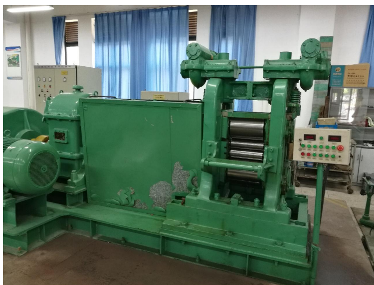
图 2-3 异步小型轧机实物图
