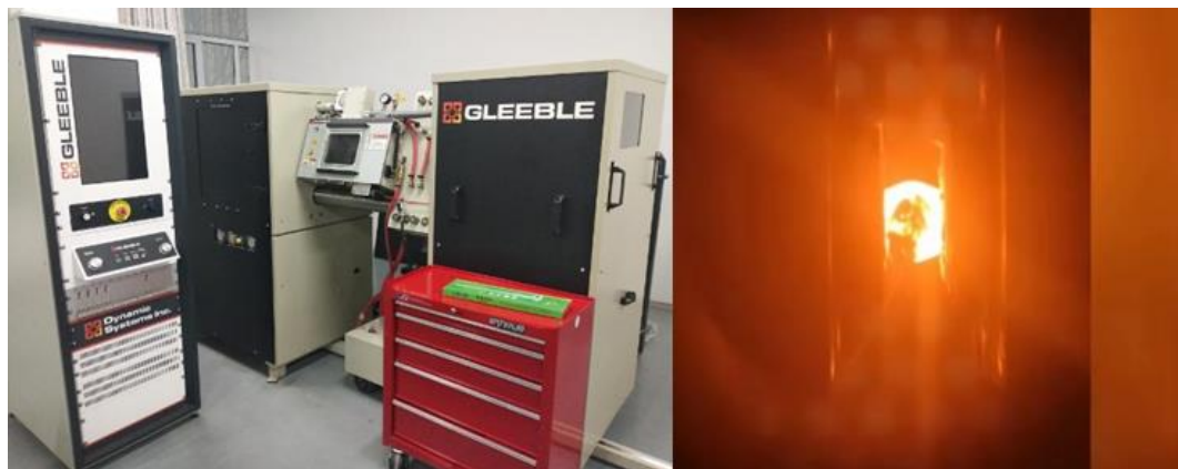
图 2-2 Gleeble-3500 热力模拟试验机及高温压缩实验
