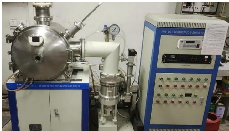
图 2-1 WK 型非自耗真空电弧炉
