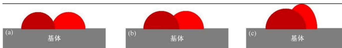
图 1-6 不同 R 值搭接率示意图: (a)R 值较小; (b)R 值适中; (c)R 值较大 [53]
