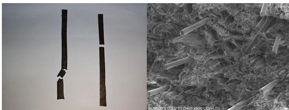
图 3-15 短切碳纤维增强木塑复合材料的拉伸断面的实物图和扫描电镜
