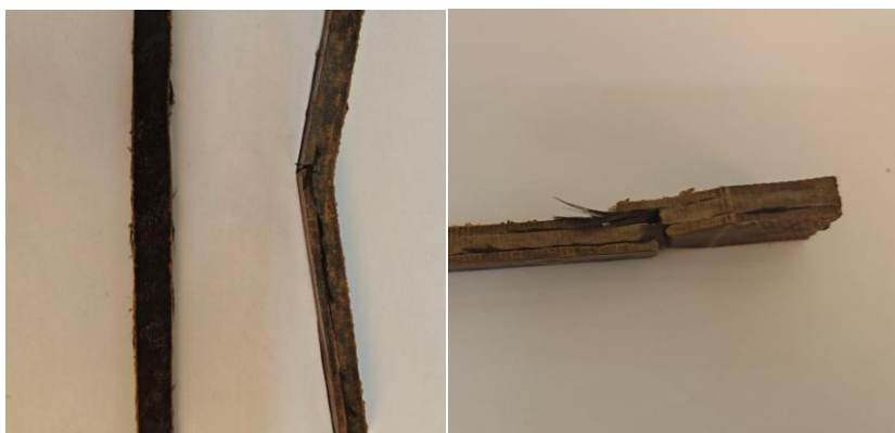
图 3-25 MAH-DPE 长连续碳纤维增强木塑复合材料断裂图
