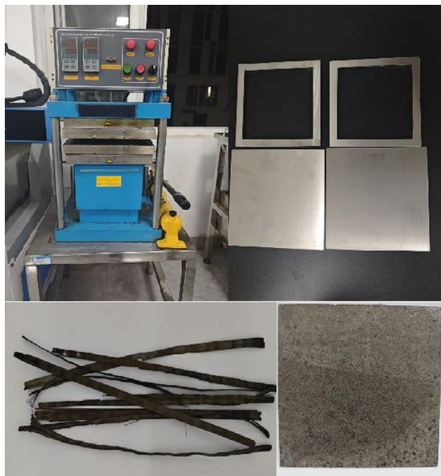
图 3-6 热压机装置、热压模具、长连续纤维和压制的板材实物图
