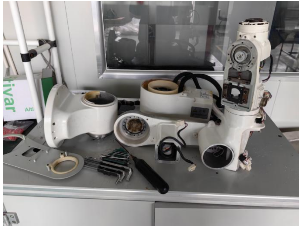
图 1-2 工业机器人拆解后的部件
