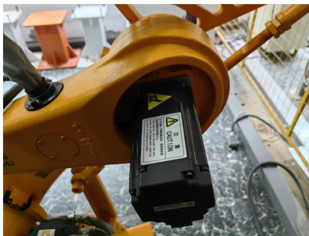
图 1-1 工业机器人传动系统
