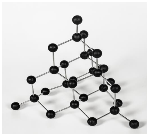
图 1-2 金刚石正四面体结构球棍模型
