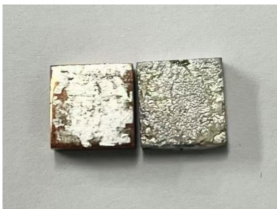
图 4-1 Sn58Bi 焊片钎焊 SiC-Cu 焊后脱落的实物图
