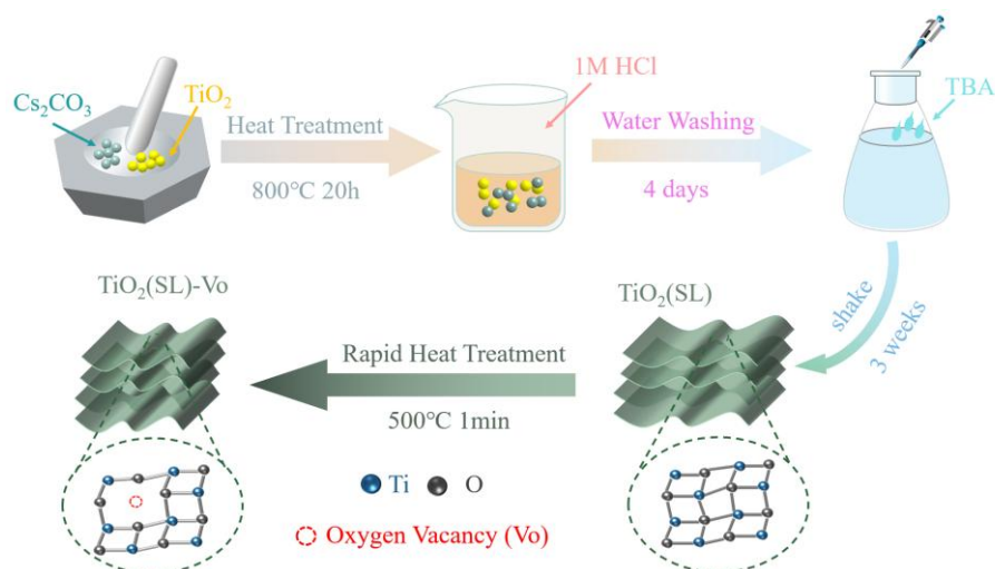
图 3-2 剥离法制备 \text{TiO}_2(\text{SL})\text{-Vo} 纳米片制备流程
