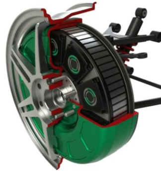
图 1-12 容错轮毂电机(纽卡斯尔大学)
