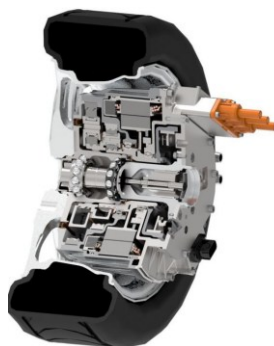
图 1-3 舍弗勒公司永磁轮毂电机
