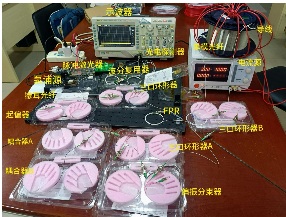
图 4-11 基于环形结构 FPR 全光纤电流传感器实验光路搭建
