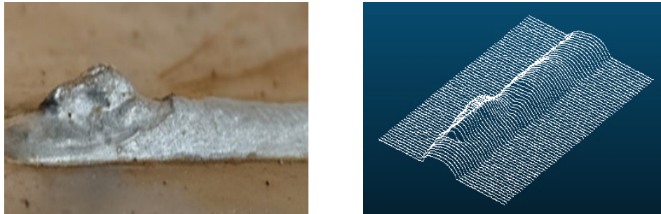
(a) 焊瘤焊缝表面
