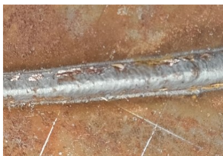
(a) 正常焊缝表面
