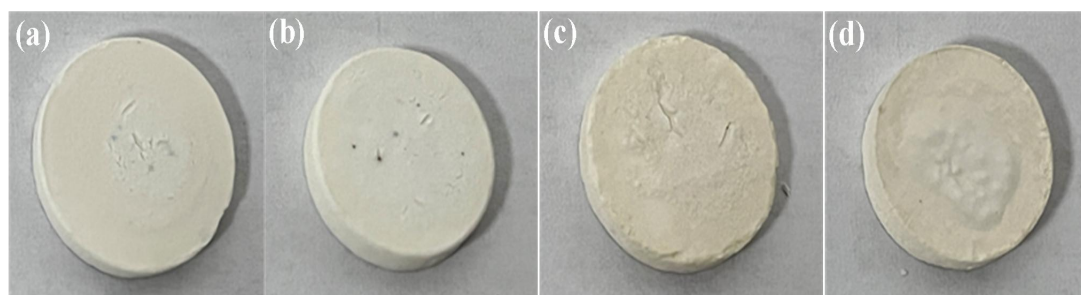
图 4-4 经 CMAS 腐蚀后不同成分陶瓷片表面宏观图片：(a) YSZ；(b) 10%REYSZ；(c) 20%REYSZ；(d) 30%REYSZ
