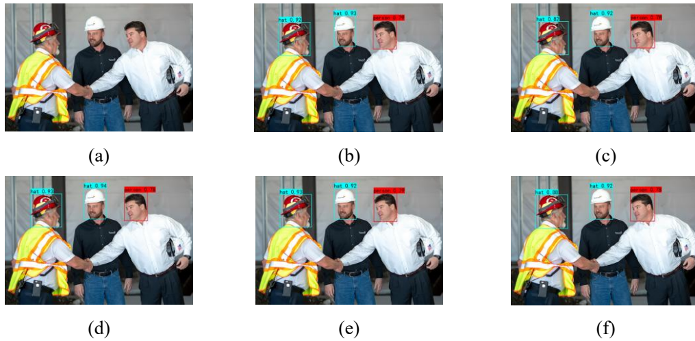
图 3-8 部分卷积比 r 取值不同时的检测结果
