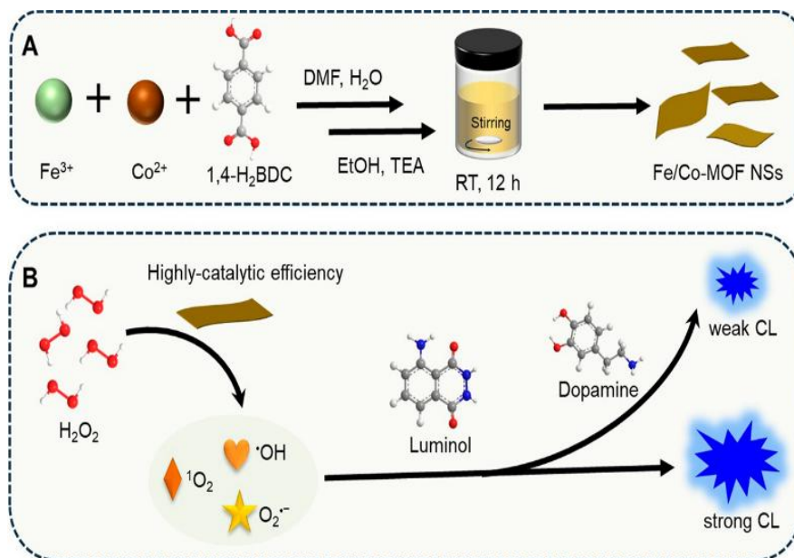
图 1-13 (A) Fe/Co-MOF NSs 的制备工艺。(B) 基于 Fe/Co-MOF NSs 的 CL 检测 DA [89] 。
