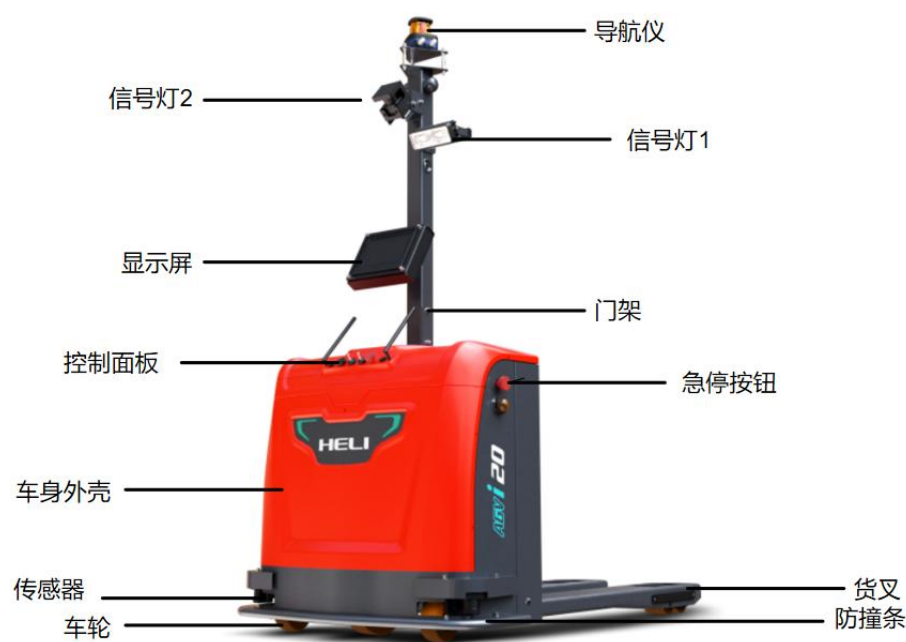
图 3-1 托盘搬运式 AGV 叉车的结构（图片来源：笔者自绘）
