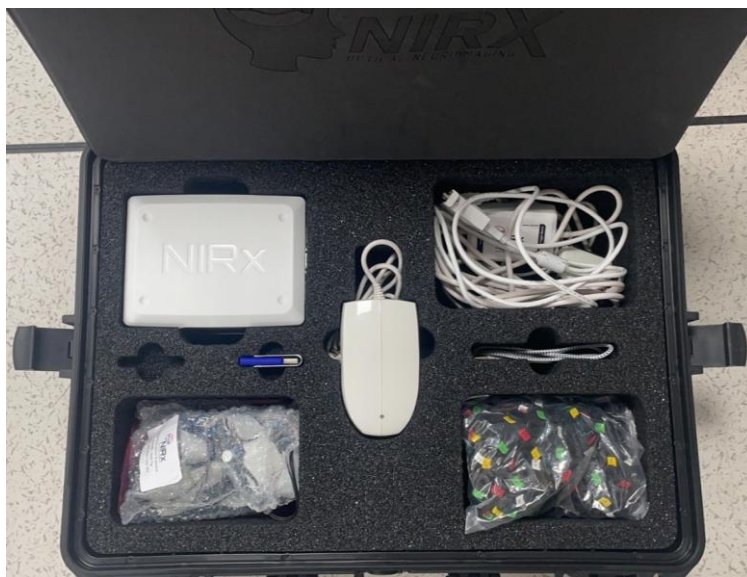
图 6-2 近红外脑功能成像实验设备
