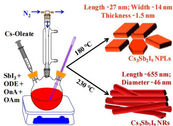
图 1-2 高温热注入法合成 \text{Cs}_3\text{Sb}_2\text{I}_9 NPLs 与 \text{Cs}_3\text{Sb}_2\text{I}_9 NRs 钙钛矿材料的示意图 [55] 。
