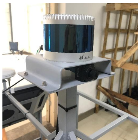
图 2-11 相机的安装位置示意图
