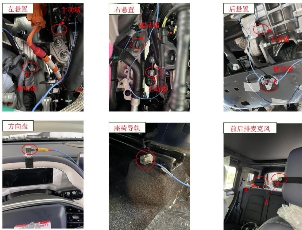
图 5-7 传感器布置示意图
