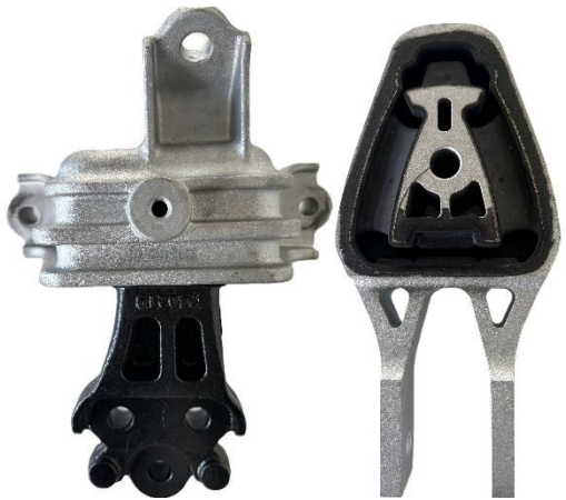
图 1-2 橡胶悬置示意图
