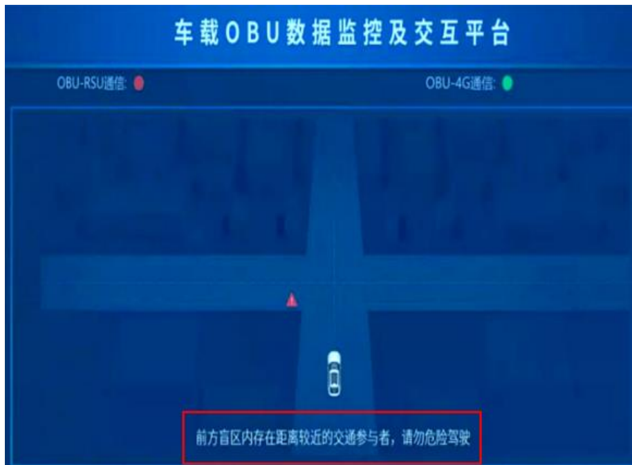
图 5-14 车载端盲区预警提示图
