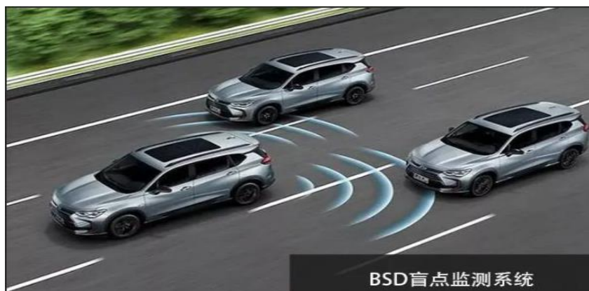
图 2-5 BSD 盲点监测示意图
