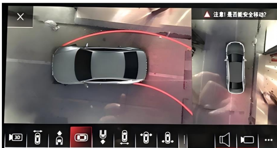
图 2-7 360°全景影像系统示意图
