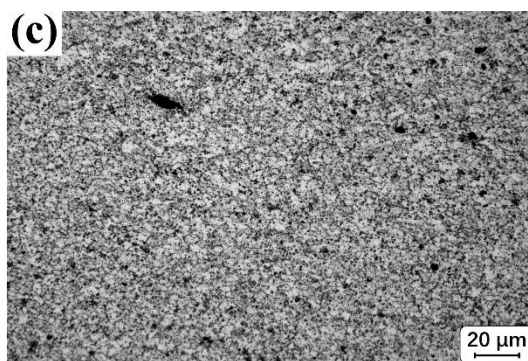
图 4-4 不同搅拌头旋转速度下增材区微观组织
