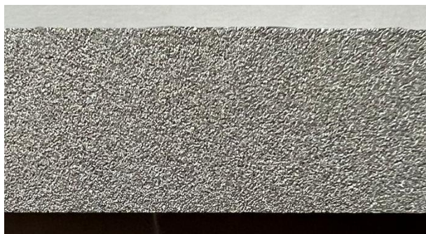
图 3-6 轨迹偏移距离为 4 mm 的宏观图
