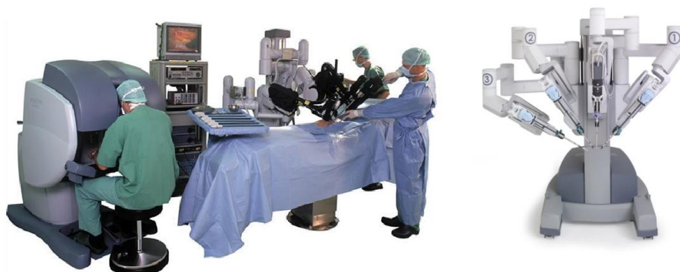
图 1-2 Da Vinci 机器人手术场景及机械臂系统
