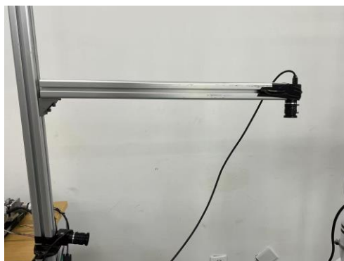
图 3-11 双目视觉跟踪相机装置
