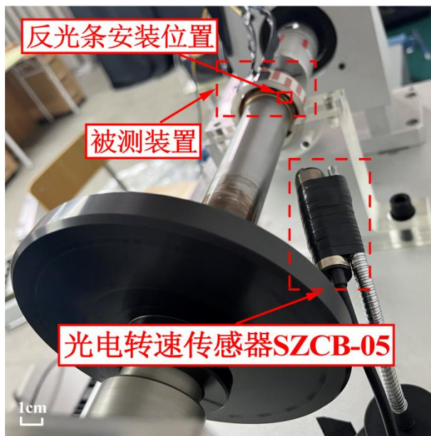
图 4-7 光电转速传感器安装位置图
