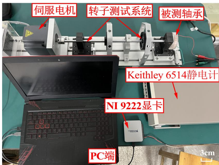
图 3-2 实验平台及电信号采集系统
