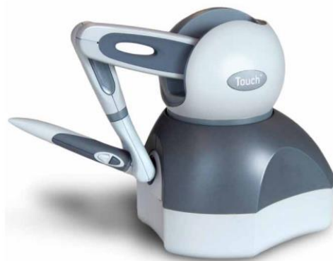
图 2-1 Geomagic Touch 操作端设备
