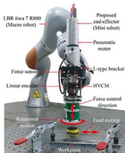
图 1-3 机器人打磨平台
