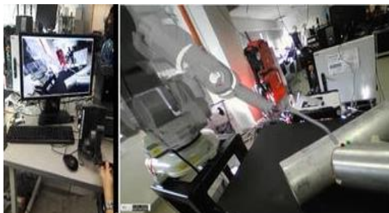
图 1-9 焊接机器人视觉 AR 和触觉界面
