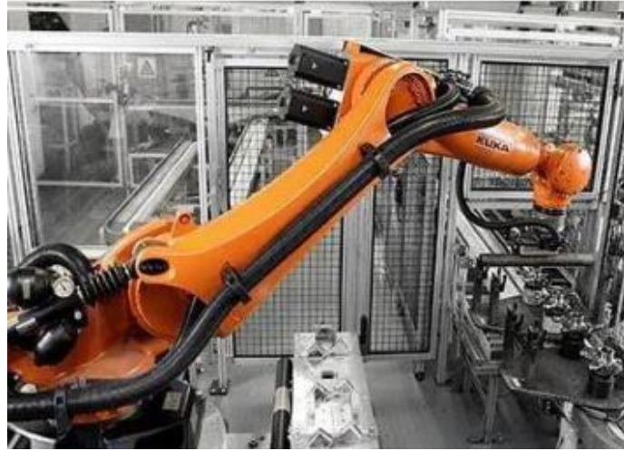
图 1-1 KUKA 打磨机器人
