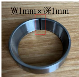
图 4-1 外圈故障轴承
