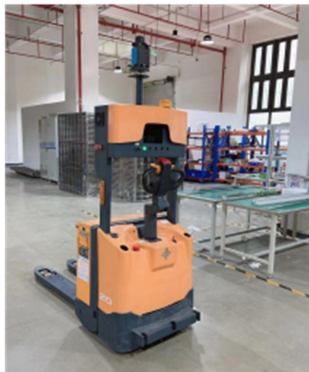
图 1-13 西华大学智能堆垛式无人叉车
