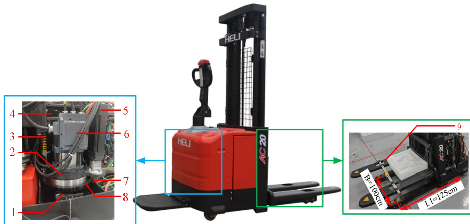
图 2-6 堆垛式无人叉车物理结构解析
