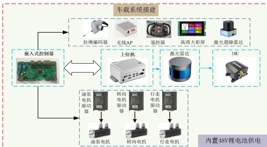
图 2-11 堆垛式无人叉车总体系统框架图
