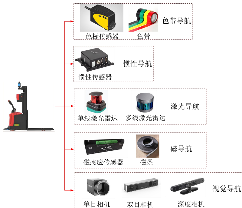
图 1-2 堆垛式无人叉车导航方式
