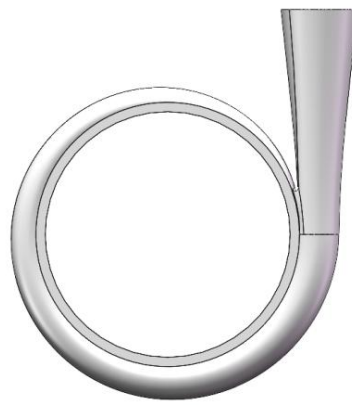
图 2-6 离心泵蜗壳三维模型
