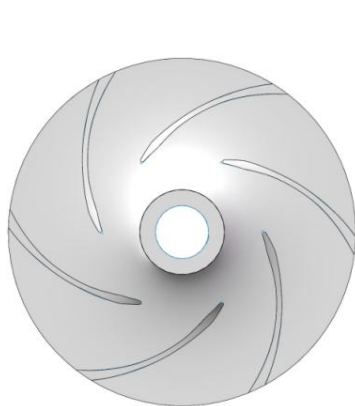
图 2-5 离心泵叶轮模型
