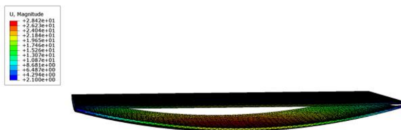
图 4-11 玻璃模压阶段位移
