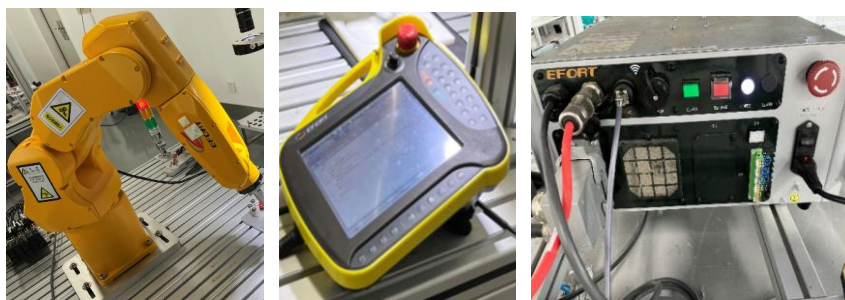
图 2-16 ER-300 机器人、示教器及控制箱
