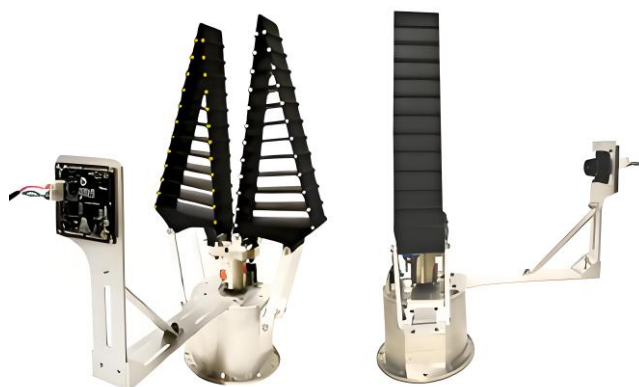
图 1-13 基于视觉相机的力感知柔性手爪
