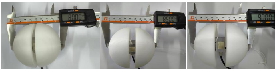
图 4-5 不同直径的球形被抓取物
