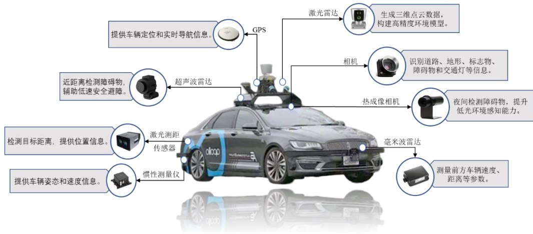
图 1-2 配备多种传感器的自动驾驶车辆
