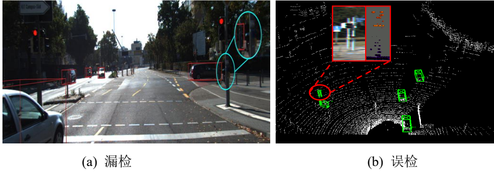
图3-1 目标检测中存在的漏检和误检现象。
