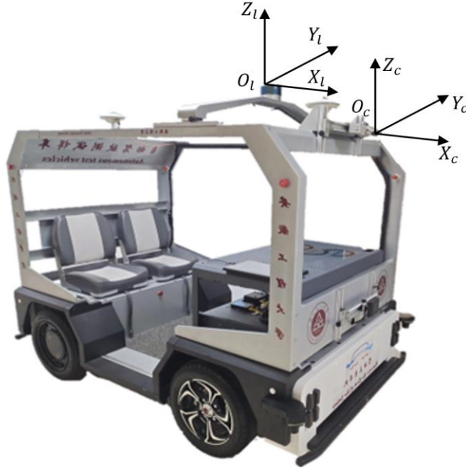
图 2-10 相机-激光雷达坐标系示意图
