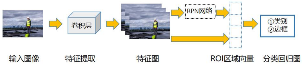
图 2-7 Faster R-CNN 流程图
