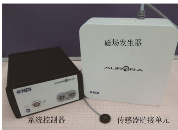
图 1-6 NDI Aurora 电磁跟踪系统组成架构
