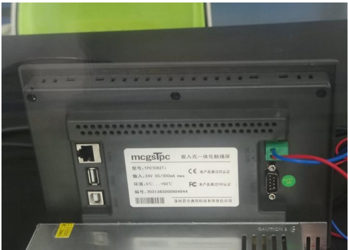
图 4-4 MCGS 触摸屏控制器
