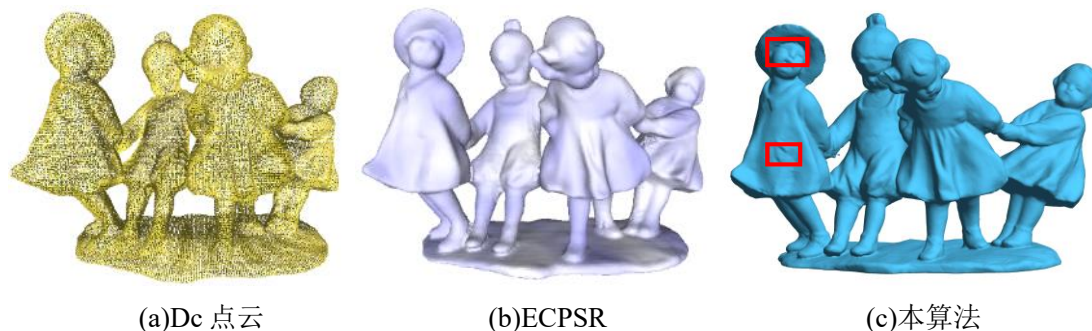
图 4-2 Dc 点云模型等值约束泊松重构与本算法重构精度比较
