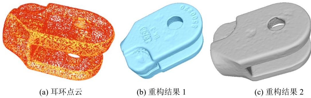
图 4-8 耳环点云重构结果
