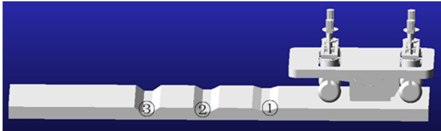
图 4-15 清扫车坑洼通过仿真图
