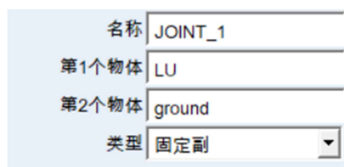
图 4-2 障碍路面固定
