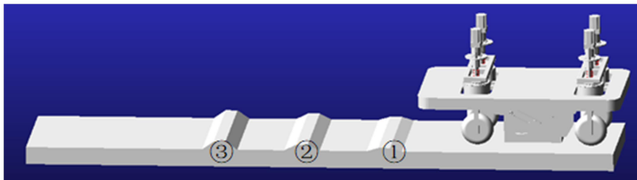
图 4-8 清扫车障碍跨越行驶仿真图
