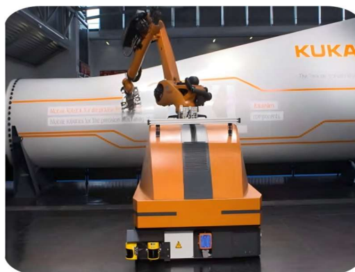
图 1-4 机器人叶片磨削系统
