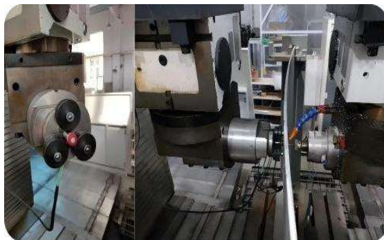
图 1-11 基于磁流变液的镜面支撑装置
