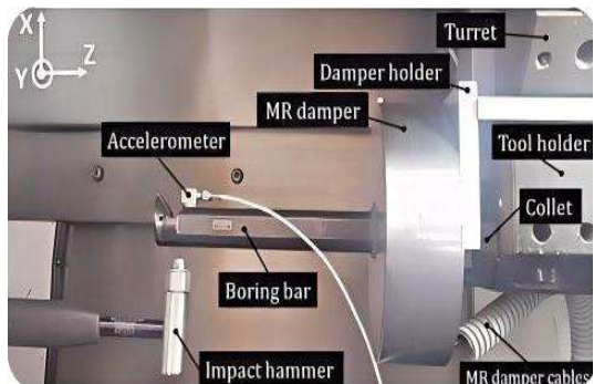
图 1-12 磁流变阻尼器用于镗削刀具
