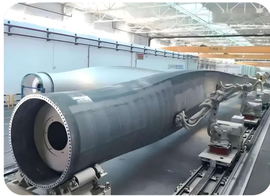
图 1-2 机器人打磨风电叶片
