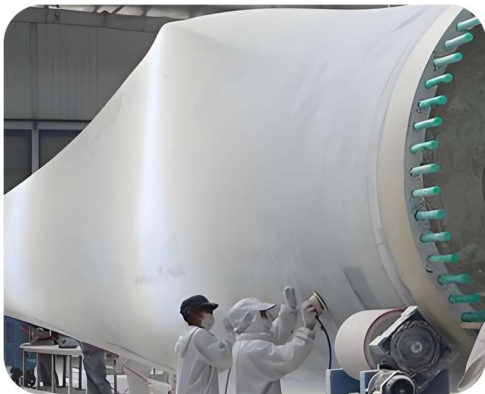
图 1-1 人工打磨风电叶片
