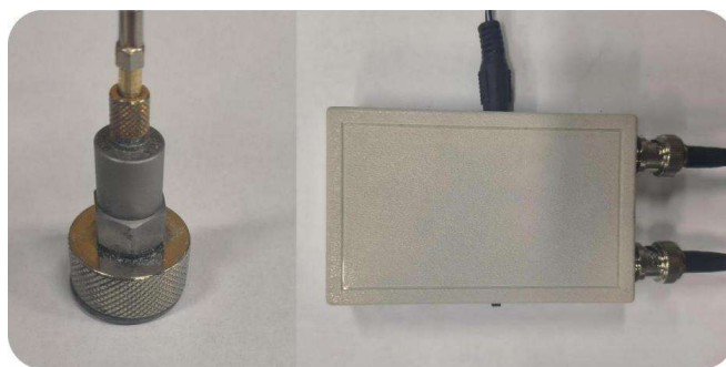
图 5-9 加速度传感器与 24\text{V} 恒流适配器
