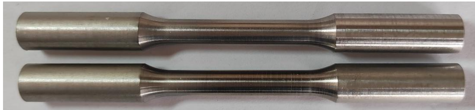
图 3-5 SLM AlSi10Mg 合金疲劳试验棒材试样
