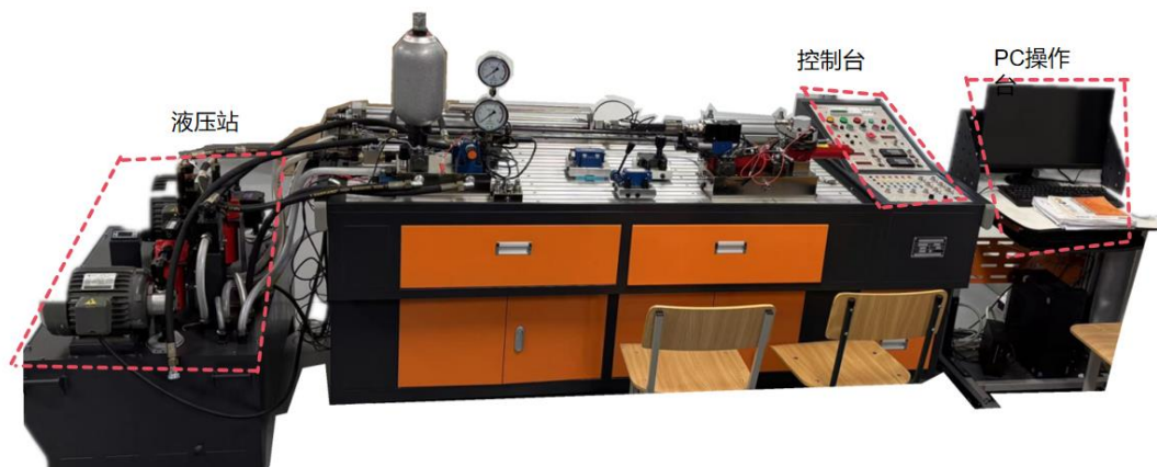
图 6-1 伺服阀力控制-实验原理图
