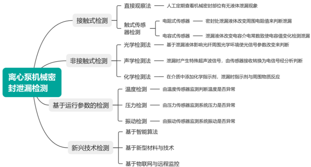
图 2-2 机械密封泄漏检测方法
