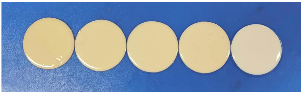
图 2-1 力致发光柔性薄膜（ZnS:Mn 2+ 和 ZnS:Cu 2+ 粉末的质量比 从左到右依次是 6:0、4:2、3:3、2:4、0:6）
