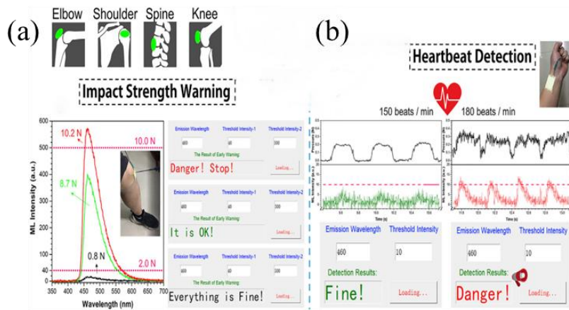
图 1-4 冲击力传感器在柔性可穿戴设备中的应用 [13] (a) 冲击强度预警 (b) 心跳检测
