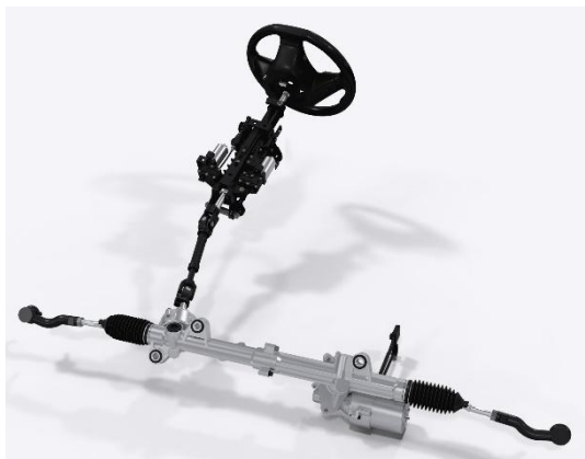
图 1-2 电动助力转向结构图
