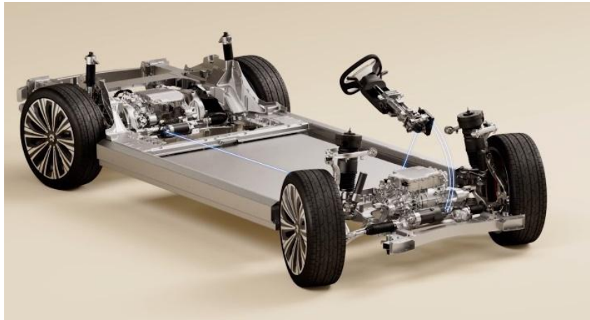
图 1-3 线控转向结构图（蔚来）
