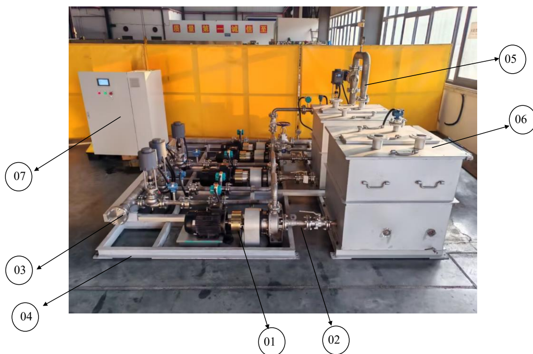
图 4-15 循环水厂泵站系统样机图
