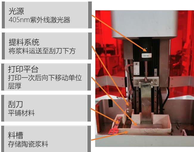
图 3-8 上曝光陶瓷打印机的工作原理图
