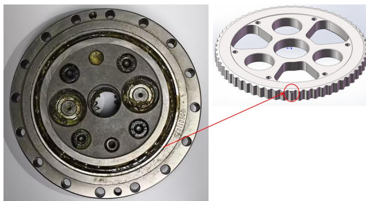
(a)摆线轮剥落故障
