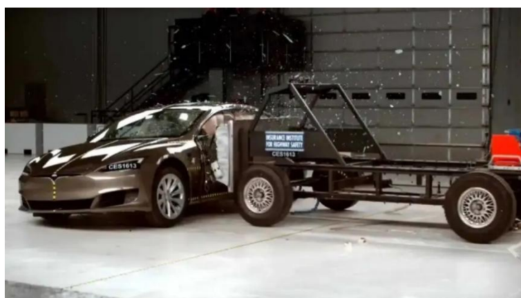
图 3-4 整车可变形壁障台车侧面碰撞试验
