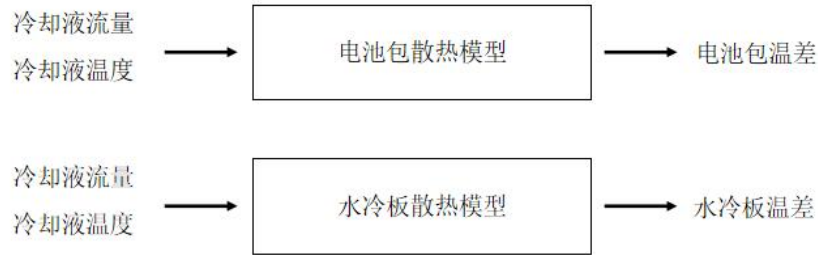
图 3-8 散热模型原理图
