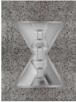
图 6-4 多层负泊松比结构
